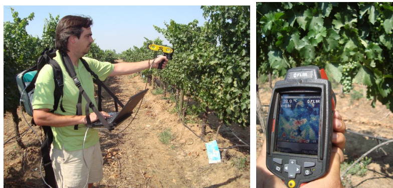
Figura 7. Fotografías del analizador espectroradiométrico portátil (The FieldSpec®) y cámara termográfica (FLIR i-Series) utilizadas.
