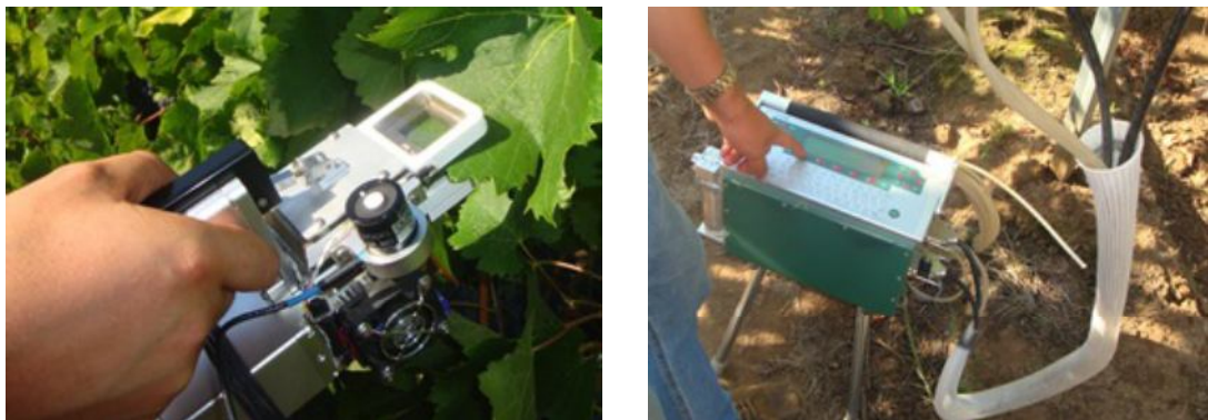
Figura 5 Fotografía de analizador infrarrojo de gases (Li-6400 Li-Cor, Inc., Lincoln, NE).
