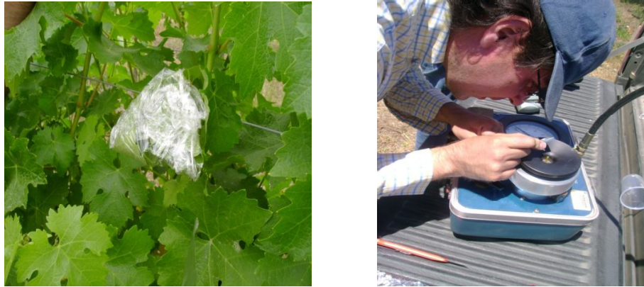
Figura 4. Fotografía de hoja aislada y medición de potencial hídrico de xilema con bomba Scholander (PMS Instrument Co., modelo 600, Corvallis, Oregon, USA).
