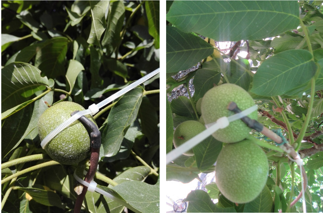
Figura 69. Frutos del nogal con instalación de termocuplas, (izquierda) fruto exposición norte (derecha) fruto exposición sur.
