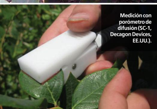
Medición con porómetro de difusión (SC-1, Decagon Devices, EE.UU.).
